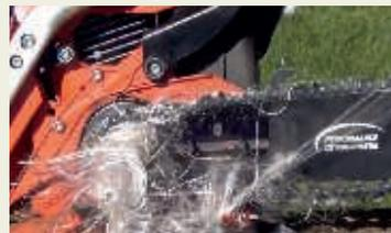
En cas de contact avec la chaîne, les fibres protectrices sont libérées et s'enroulent autour du pignon, stoppant la chaîne en environ 60 millisecondes.
